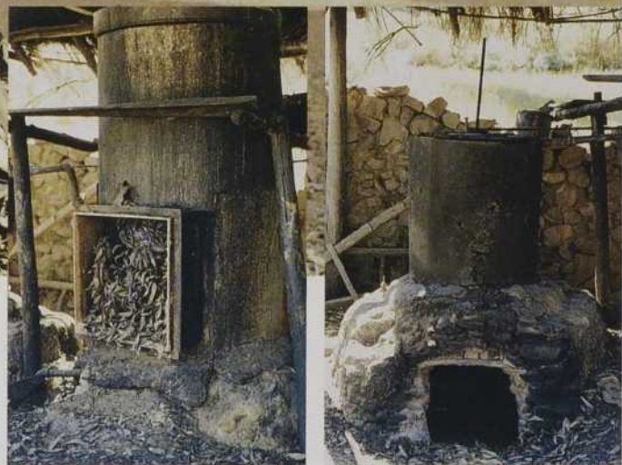
L'extraction de l'huile essentielle, un art plusieurs fois millénaire. Une fois les végétaux récoltés (ici, des feuilles d'eucalyptus), on parvient, avec des outils rudimentaires (à gauche, un extracteur et, à droite, une chaudière) à obtenir les substances recherchées.
