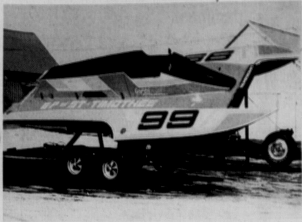
Le nouveau GP 99 de Pierre Lavigne de Beauharnois est une embarcation de 24 pieds de longueur construite en Arizona. Le bateau est propulsé par un moteur Chevrolet 461 cc. sur-comprimé et alimenté au méthanol. Le moteur a été préparé par
