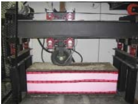
Simulateur de sollicitation mécanique utilisé pour valider les modèles de déformation permanente des matériaux de chaussées (Projets 1A-1 et 1A-3)
