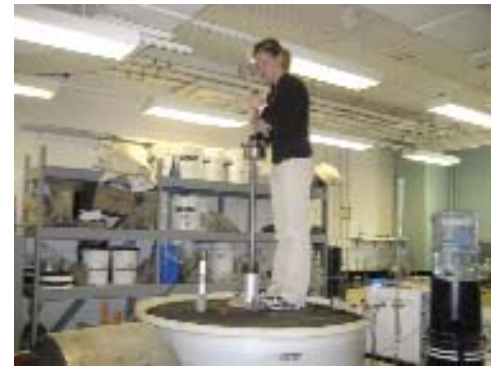
Mesure de la récupération mécanique des matériaux de chaussées en cuve d'essai à l'aide d'un déflectomètre portable pour l'évaluation de l'efficacité des systèmes de drainage en laboratoire (Projet 1B-1)
