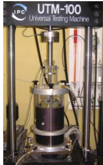
Cellule triaxiale à chargement répété utilisée pour l'étude des propriétés résilientes et du comportement en déformation permanente des sols et des matériaux granulaires non-liés (Projets 1A-1, 1A-2 et 1A-3)
