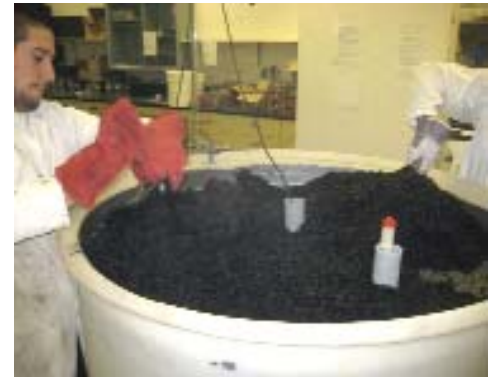
Mise en place de la couche d'enrobé bitumineux pour finaliser le montage de la cuve d'essai pour l'évaluation de l'efficacité des systèmes de drainage en laboratoire (Projet 1B-1)
