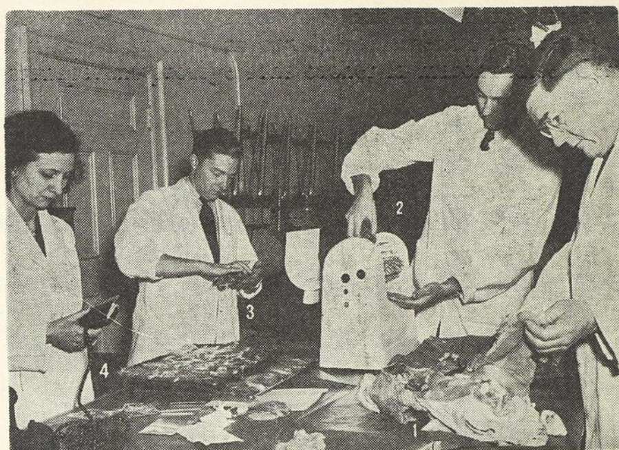
Fabrication du steak de dindes :— 1- Levée de la viande de poitrine 2- Transformation en steak 3- Empaquetage 4- Fermeture à la chaleur
