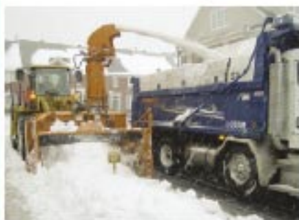
Souffleuse détachable LARUE D55 mécanique, 275 hp, 8500 lb, vis à ruban de 36 po., turbine de 40 po. et chute télescopique
