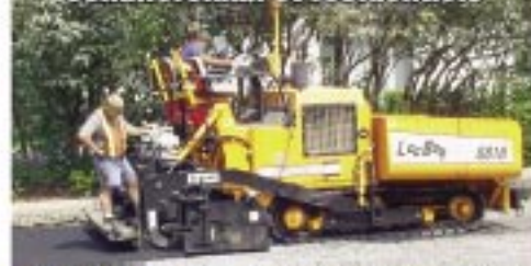
LeeBoy 8816 Moteur Cummins de 130 hp, table Legend™ 8 à 16 pi avec 109% de pente sur les extensions, vis d'alimentation de 14 po à vitesse variable et portes découpées
