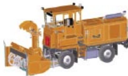
Souffleuse automotrice LARUE T60 R36 à propulsion hydrostatique, moteur Cat C9 350hp, vis à ruban de 36 po., turbine de 40 po. et chute télescopique
