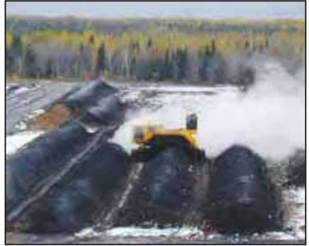
Compostage en andains retournés sur aire ouverte Photo : SOLINOV
