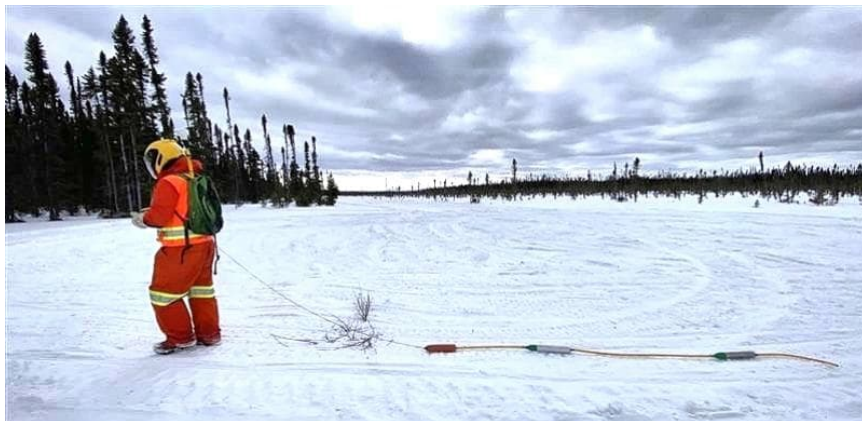
Photo D.3 — Équipement de radar à pénétration de sol – Antenne 12,5 MHz
