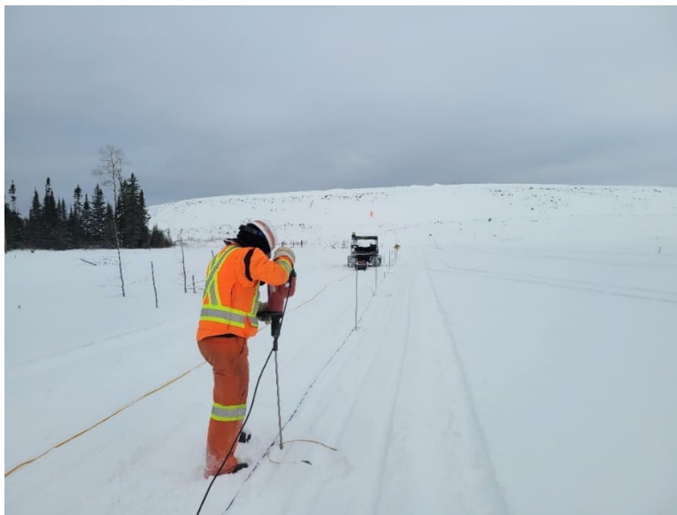
Photo D.1 — Équipement de tomographie de résistivité électrique (TRE)
