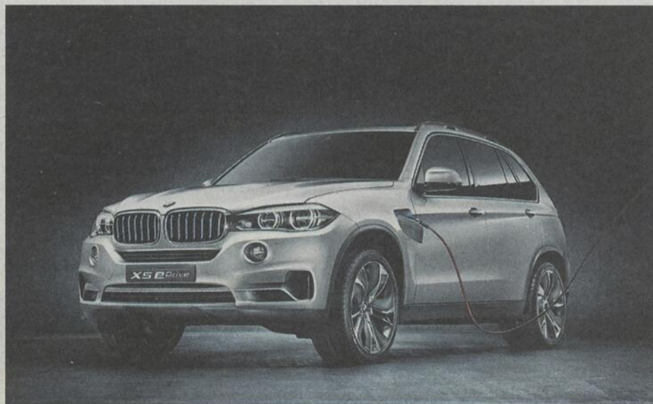
BMW a présenté le concept X5 eDrive à moteur hybride rechargeable qui combine un L4 turbo à un puissant moteur électrique de 70 kW. Consommation annoncée: 3,8 L/100 km.
