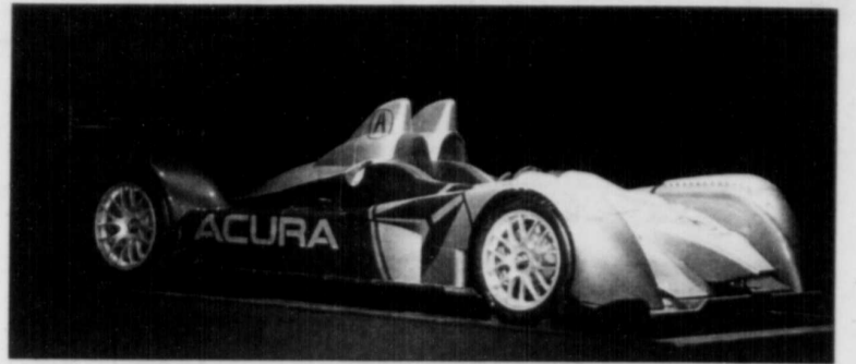
L'engin, entièrement conçu et mis au point dans les installations californiennes de Honda Performance Development, sera mû par un puissant moteur V8 atmosphérique de 3,4 litres. — PHOTO ACURA
