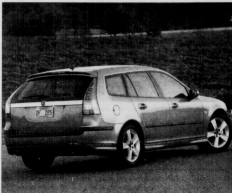
À peine plus longue que la berline dont elle dérive, cette Combi Sport conserve un faible porte-à-faux arrière, gage d'équilibre. — PHOTO SAAB
