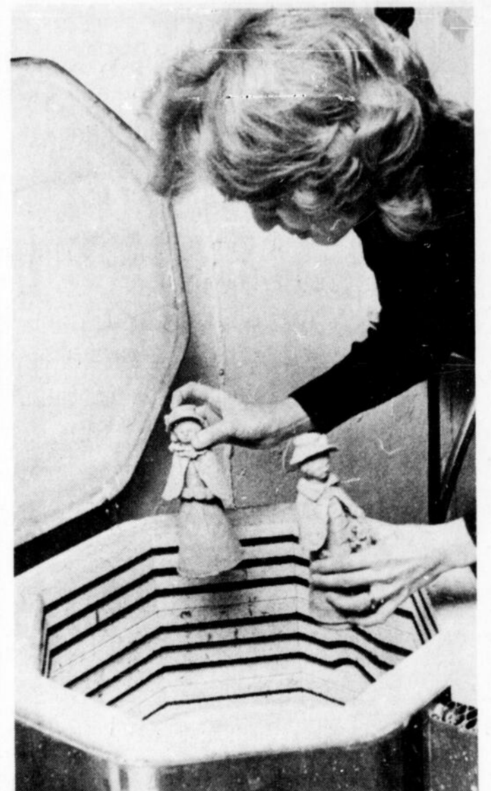
LE FOUR A POTERIE est assez profond pour pouvoir y cuire plusieurs pièces à la fois, séparées par des tablettes posées sur des supports de hauteur voulue. Les objets à cuire y sont placés à four froid et retirés à four refroidi. La température du four peut monter au-delà de 1,000 degrés.
