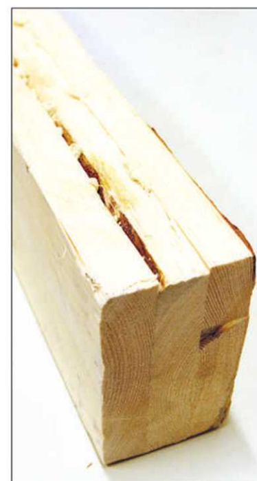
Des bouts de bois savamment assemblés constituent le «bois construit». — PHOTO LE SOLEIL, JOCELYN BERNIER
