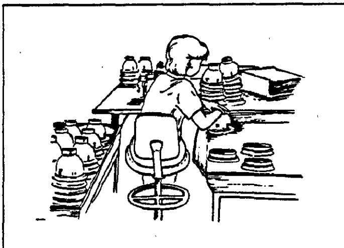
Figure 3.1 : Vue d'ensemble du poste d'assemblage des réflecteurs. Notez l'effort requis pour fixer le déflecteur au réflecteur.
