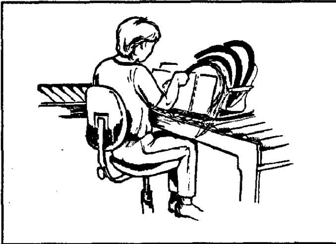
Figure A-13 : Poste 2, hauteur de l'assise à son maximum.
