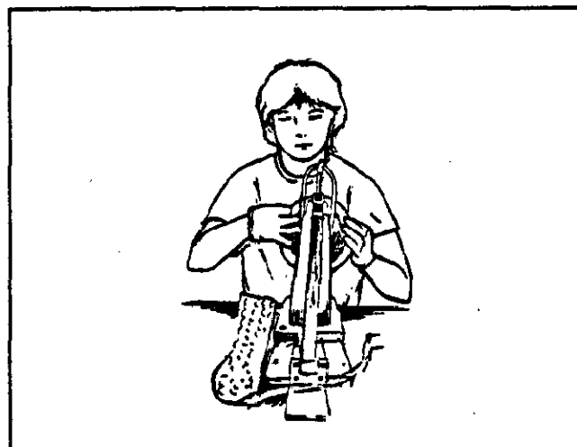
Figure 3.2 : Assemblage de ressorts à l'aide du "pc ressort".
