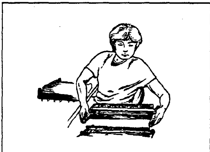
Figure 3.16 : Aperçu du réaménagement prévu par l'entreprise - Notez la torsion du dos lors du dépôt du cabaret.
