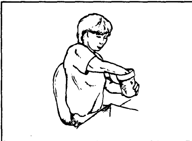
Figure A-2 : La travailleuse doit insérer une douille à l'intérieur du réflecteur. L'opération implique un effort, des pressions mécaniques et entraîne une posture contraignante de l'épaule et du poignet.
