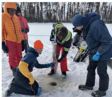
Figure 3 : Extraction d'une séquence sédimentaire avec un carottier Uwitec (crédit : Jean-Sépet M.).
