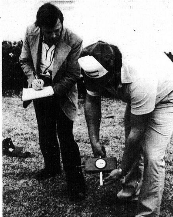
Je prends des notes pendant que Steve Vogts, de la compagnie Berkley, procède à des essais d'élongation, lors d'un séminar d'étude sur les lignes à pêche.
