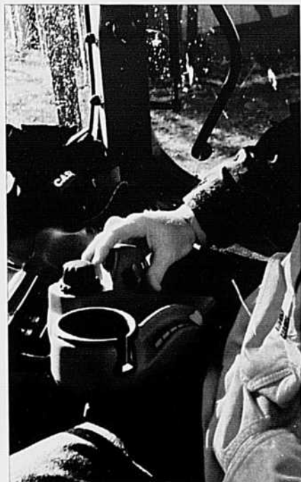
L'accoudoir droit regroupe les commandes les plus courantes actionnées par une simple pression.
