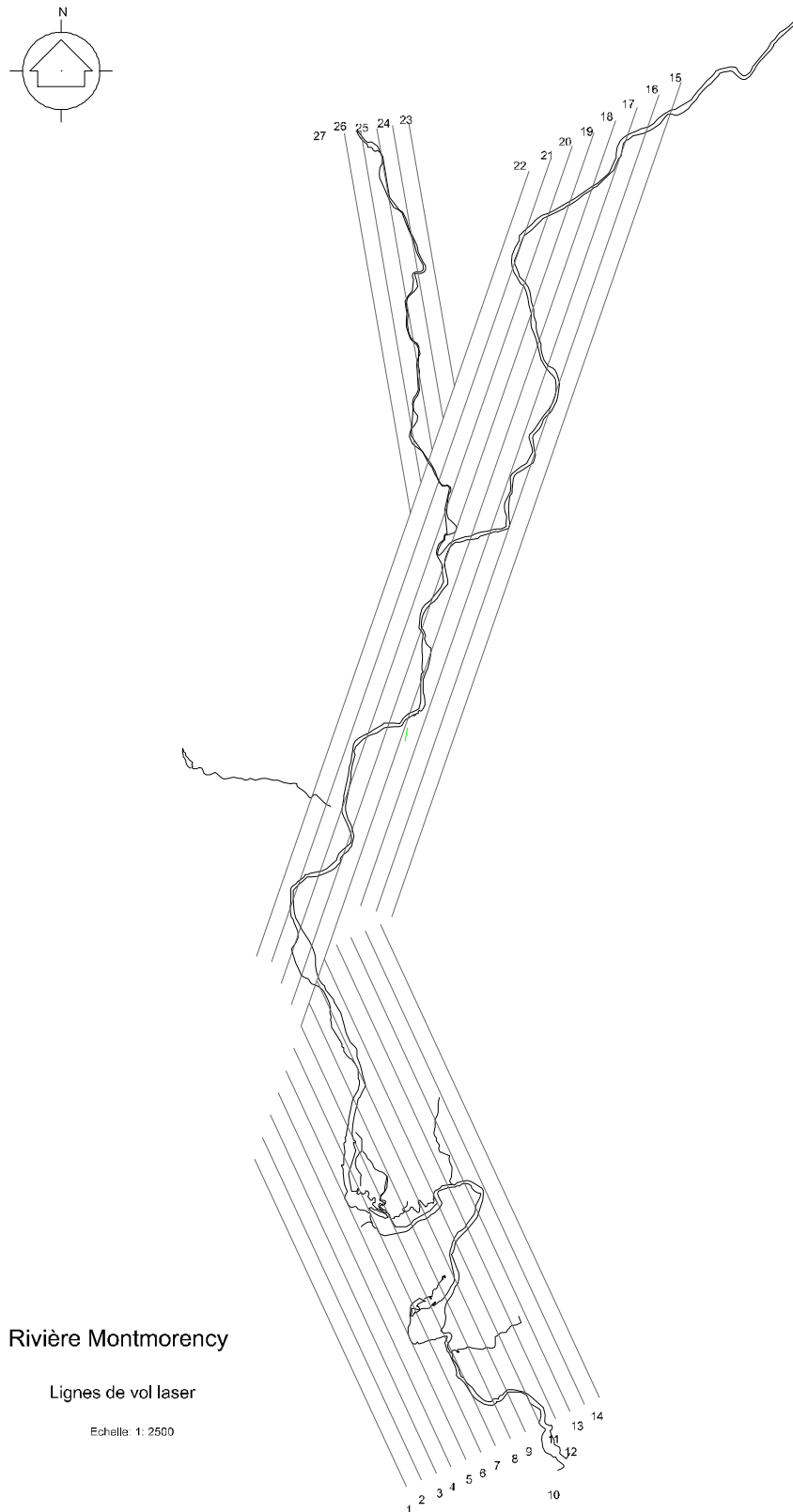
Figure 4 : Lignes de vol de la campagne de levé par balayage laser aéroporté.
