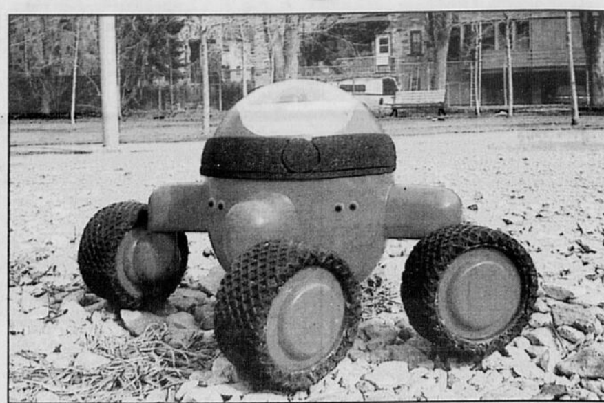
Conçu par Hugues Rissmann, ce prototype de robot chasseur d'oiseaux dans les aéroports faisait partie de l'exposition des finissants de la faculté de l'aménagement de l'Université de Montréal.
