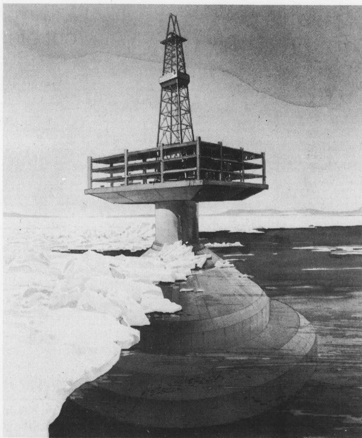
Cette "pyramide circulaire" a été un des premiers concepts envisagés pour extraire sans danger le pétrole qui gît sous la mer de Beaufort. D'autres idées encore plus audacieuses pour résoudre la question des forces gigantesques exercées par les glaces de l'océan Arctique sont à l'étude chez Gulf. Quelle que soit la solution adoptée, il faudra investir des millions de dollars avant que le premier baril de pétrole brut n'arrive aux raffineries.
