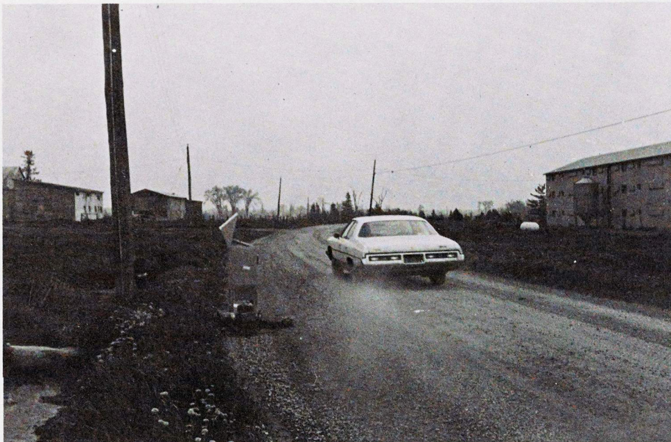
Photo - Appareillage pour l'exécution des mesures de poussières no 1 (automobile, pot, appareil Soiltest, génératrice)
