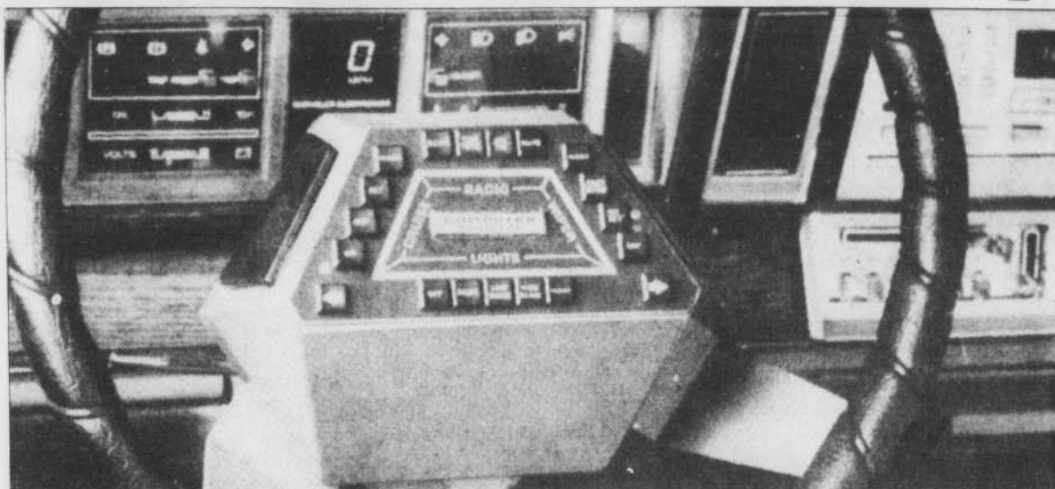
Monté dans une Dodge 600 ES le dispositif multiplex développé par la division électronique de Chrysler regroupe au centre du volant les principales commandes d'accessoires. Grâce à un ordinateur le système multiplex envoie dans les fils électroniques des impulsions de bas voltage, ce qui permet d'utiliser un conducteur pour plusieurs fonctions.
