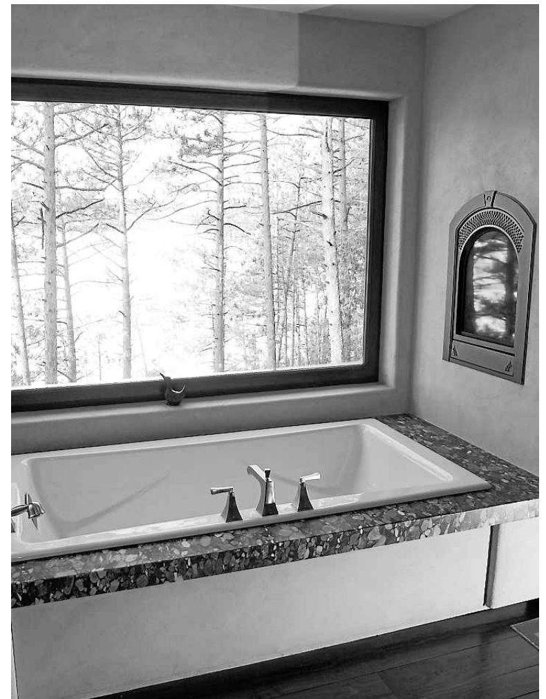
L'enduit de chaux capte l'excès d'humidité dans l'air et le rediffuse lorsque l'air est plus sec. L'effet est remarquable dans une salle de bain.
