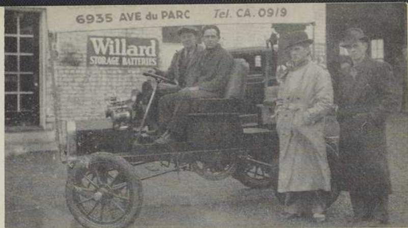
AUTRE "ANCÊTRE" ANONYME, MÛ À LA VAPEUR. ON DISTINGUE LA CHAÎNE QUI TRANSMETTAIT LA PUISSANCE DU MOTEUR À LA ROUE MOTRICE. ICI ENCORE, LES PHARES SONT AU PÉTROLE.
