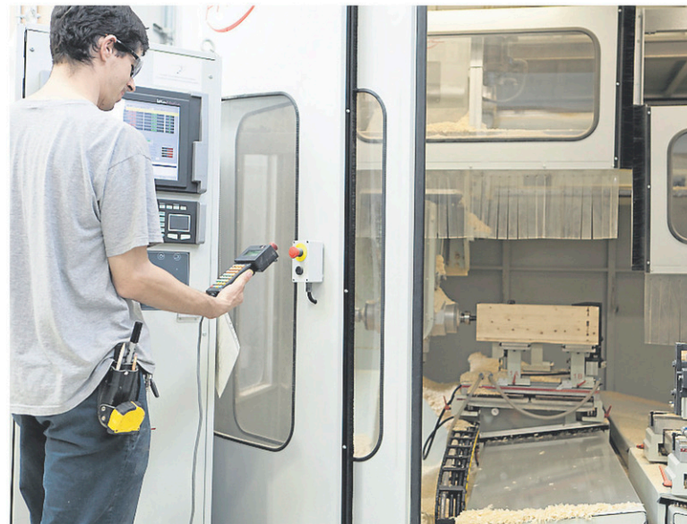
Les nouvelles technologies, comme cette délignieuse optimisée de planches à haute cadence, requièrent une formation. — PHOTO FOURNIE PAR USINE J.M. CHAMPEAU
