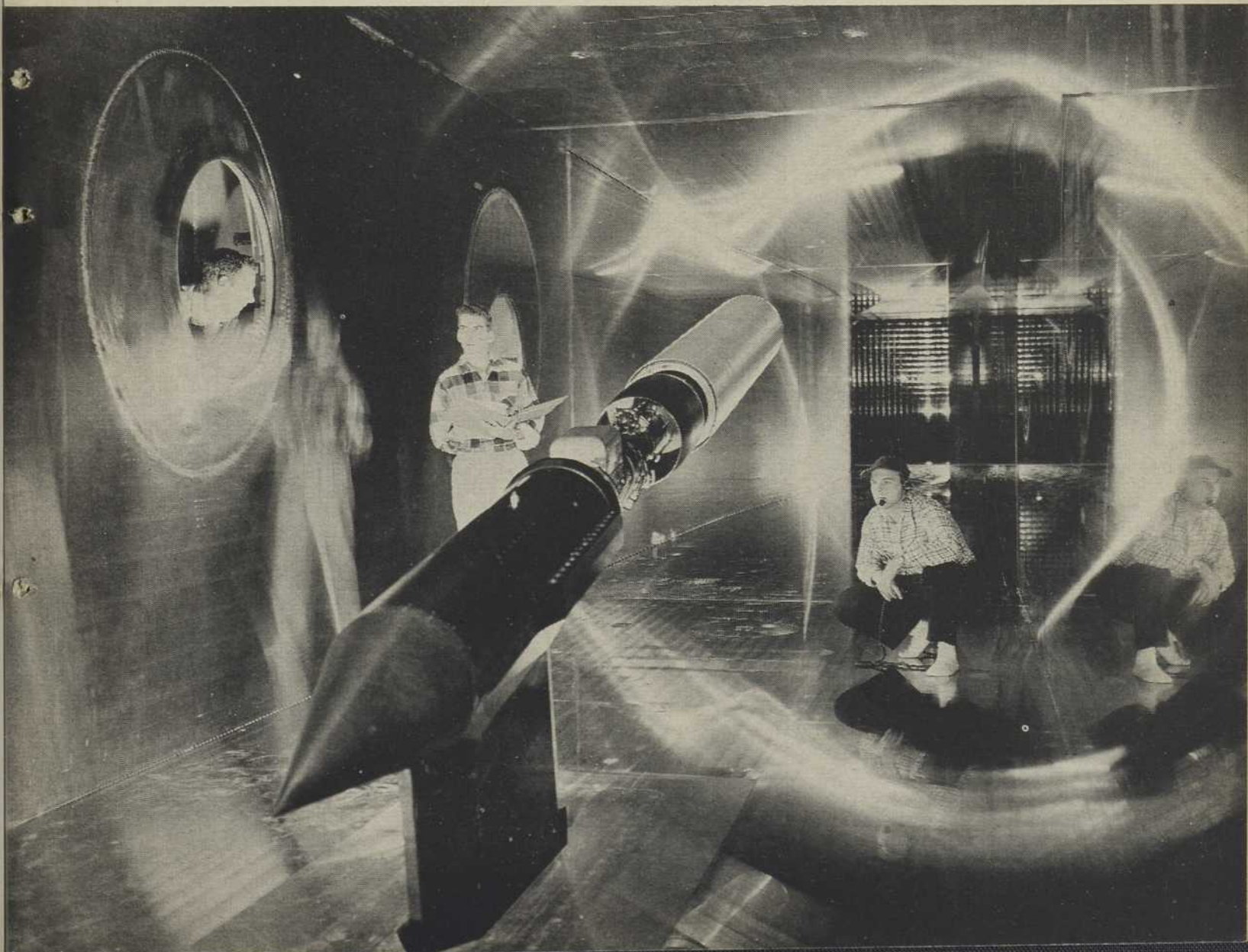
VERIFICATION, EN CHAMBRE D'EPREUVES, D'UN MODELE DE BOUCHE D'ADMISSION.
