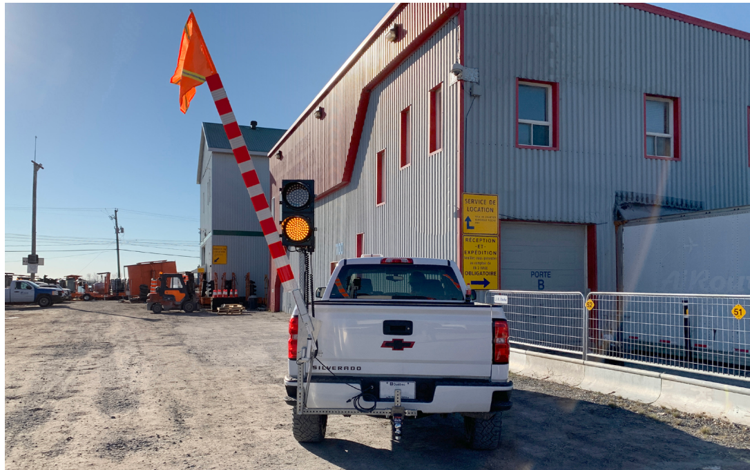
Barrière de contrôle de la circulation pour travaux fixée à un véhicule
