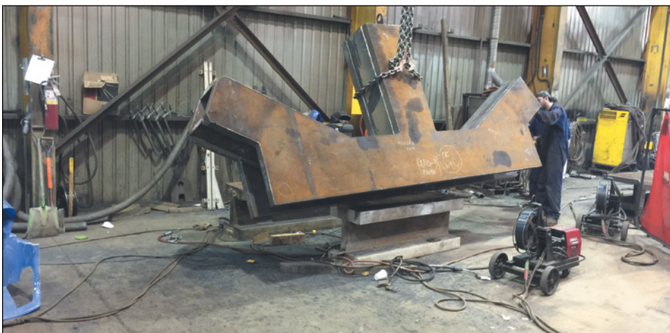
Géni-Métal a complété récemment un contrat de surveillance de fabrication de connexions rigides de la structure d'acier du World Trade Center Tower III de New York.
