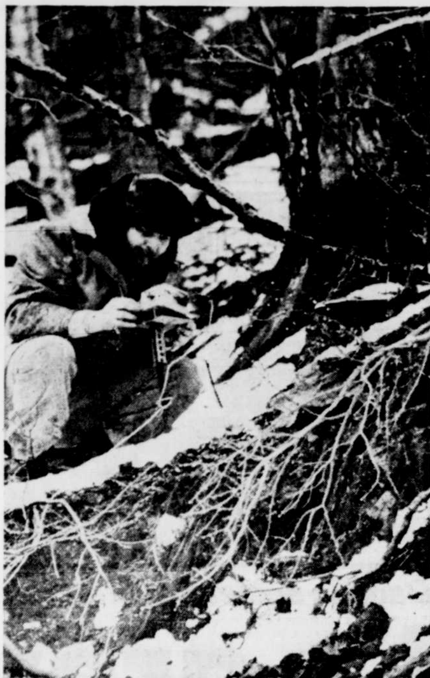
M. Robert Bergeron, du ministère de l'Énergie et des Ressources, a effectué d'autres lectures sur l'inclinomètre installé dans la falaise de Silery, près de la côte de l'Église, hier.
