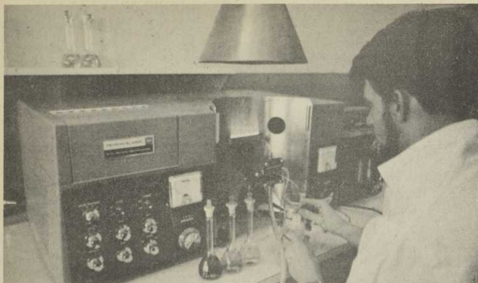
Figure 4 — Dosage des éléments minéraux d'un sol.
