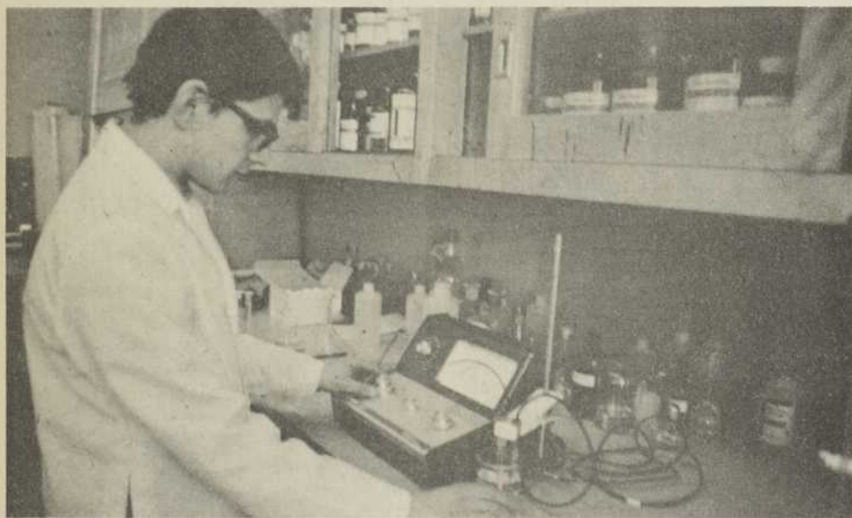
Figure 5 — Mesure de l'acidité d'un sol en laboratoire au moyen d'un Phmètre.
