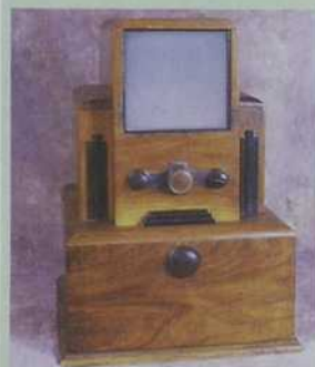
Téléviseur mécanique conçu par Alphonse Ouimet en 1932.
