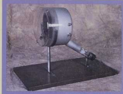
Iconoscope incorporé aux premières caméras de télévision vers 1940
