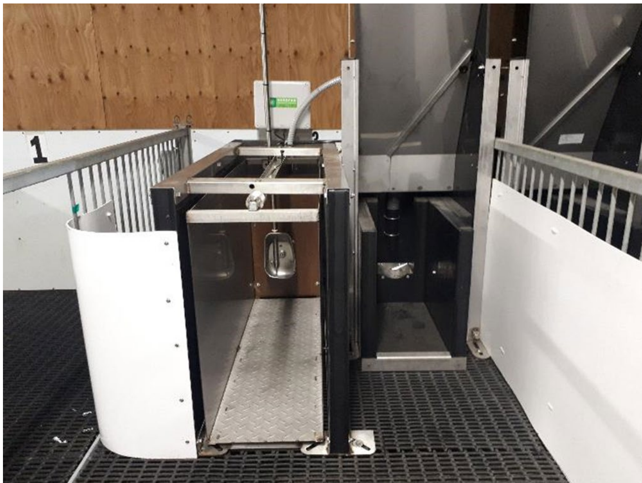
Figure 1 Système PigInsight® d'Asserva incluant une station d'abreuvement avec balance (à gauche) et une station d'alimentation (à droite).
