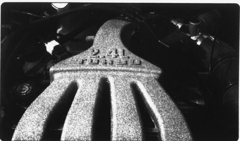
L'ajout d'un turbo hausse la puissance du 2,4 litres de 150 à 215 chevaux.
