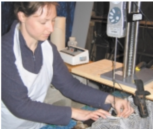
Andrée-Anne Lachance, étudiante à la maîtrise à l'ISMER, en train de mesurer la force nécessaire pour détacher une moule de deux ans à l'aide d'un crochet relié à un dynamomètre. Photo : Jacques Richard, STMIM
