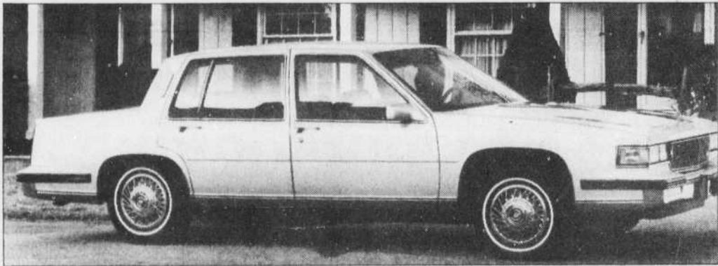
Avec sa traction avant, son moteur V-8 transversal et ses 272 kilos en moins, la Cadillac Fleetwood fait partie de la nouvelle génération des modèles «C» de General Motors.
