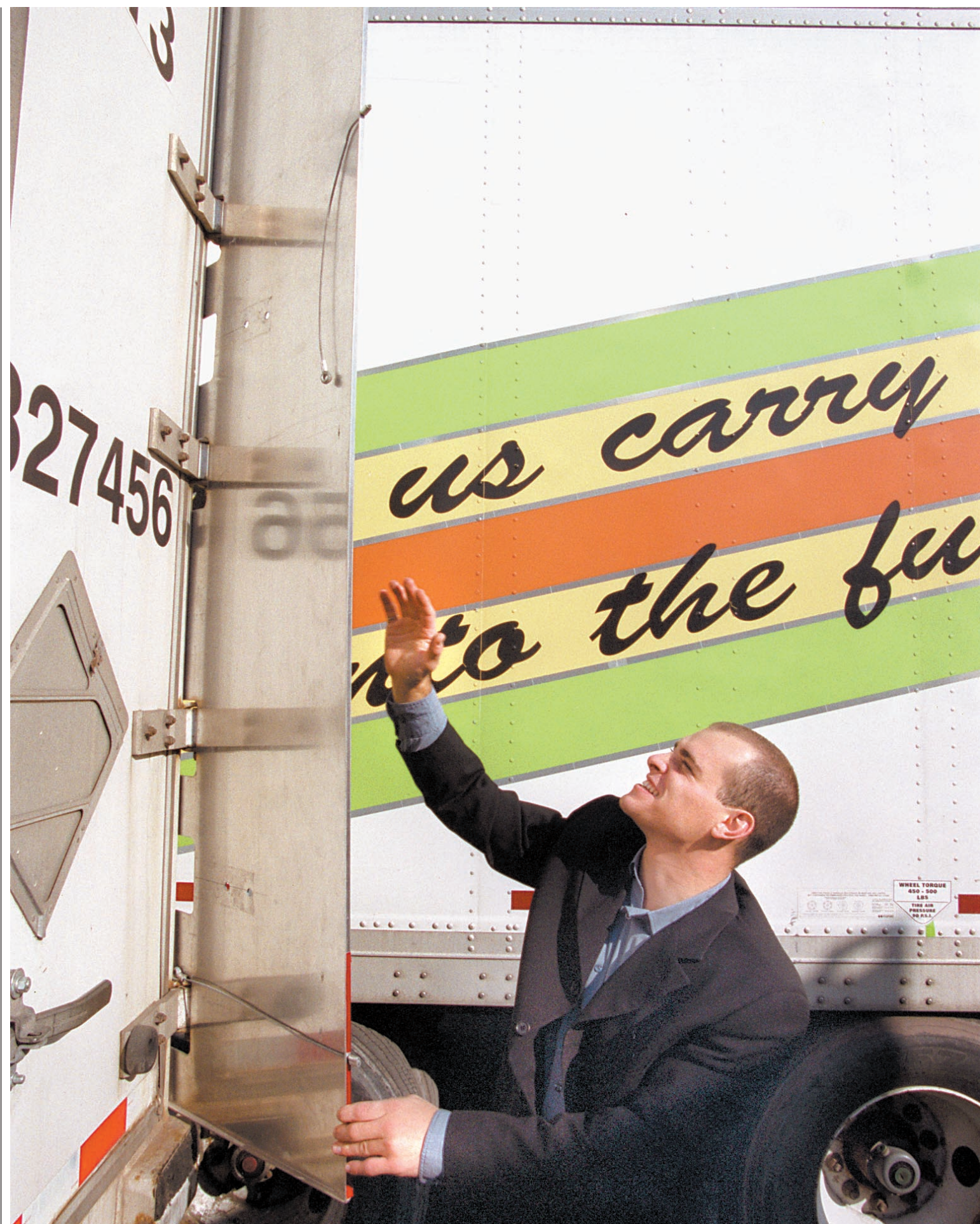
Mathieu Boivin nous montre les déflecteurs qui, installés à l'arrière des remorques, permettent une économie d'environ 2000 $ d'essence par année.
