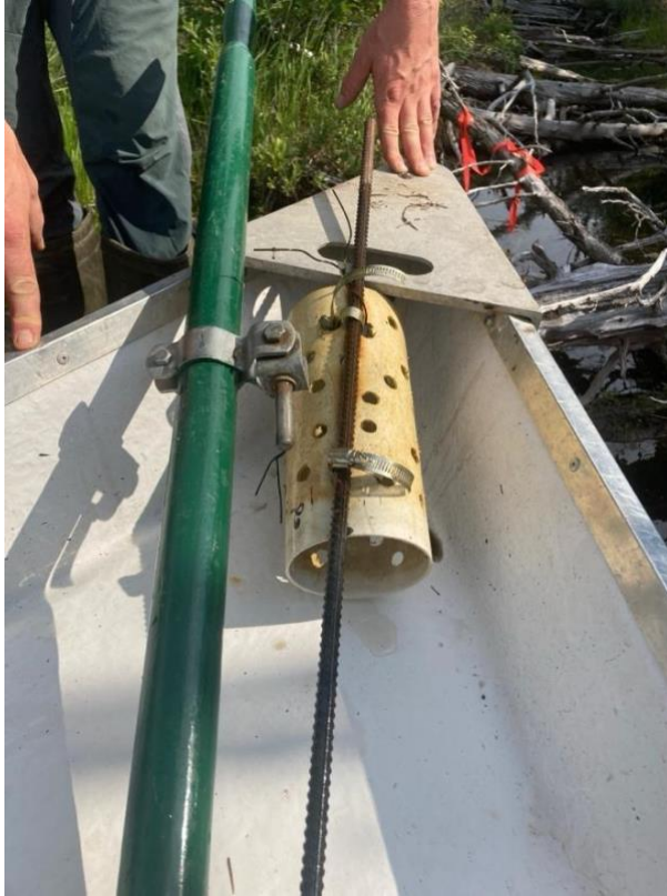
Installation des thermographes dans les tubes de PVC troués
