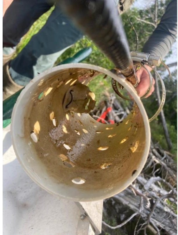
Installation des thermographes dans les tubes de PVC troués
