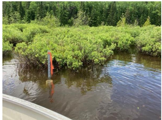
Installation des thermographes dans les tubes de PVC troués
