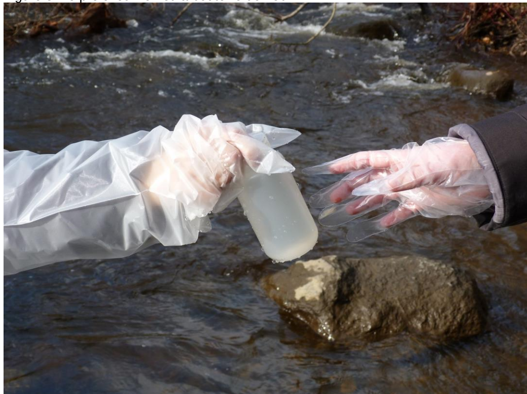
Figure 3. Le préleveur remet la bouteille de 250 ml à l'assistant.
