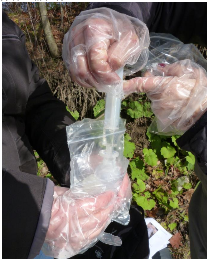
Figure 14. À l'intérieur des sacs, le préleveur filtre 20 ml d'eau de surface dans la bouteille de conservation de 60 ml acidifiée.
