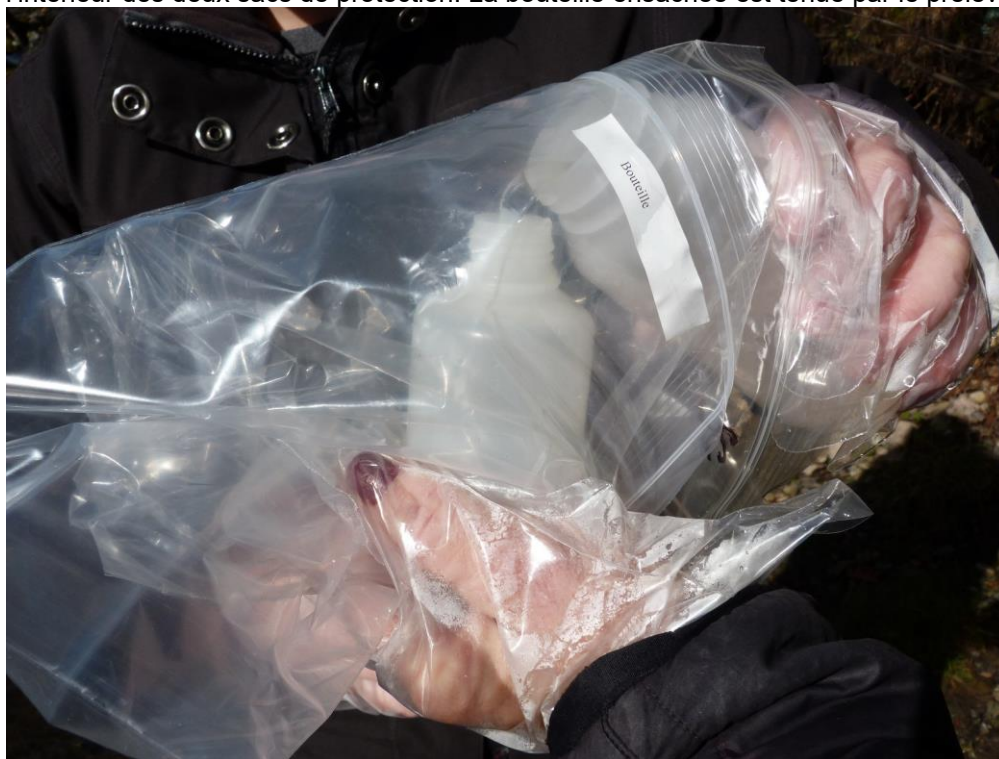
Figure 6. Le préleveur referme rapidement le bouchon de la bouteille de conservation ainsi que les deux sacs.
