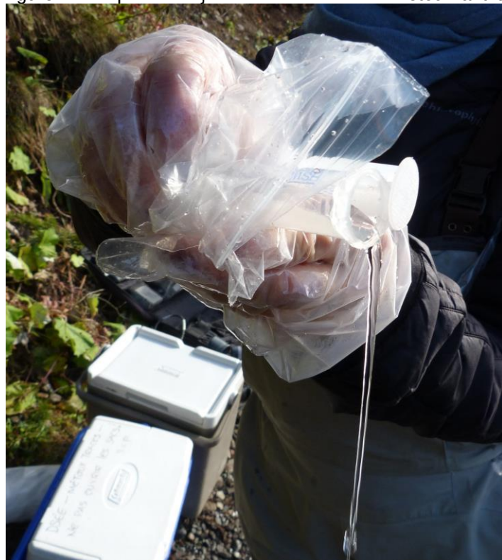
Figure 12. Le préleveur jette l'eau du barillet en retournant la seringue vers le bas.
