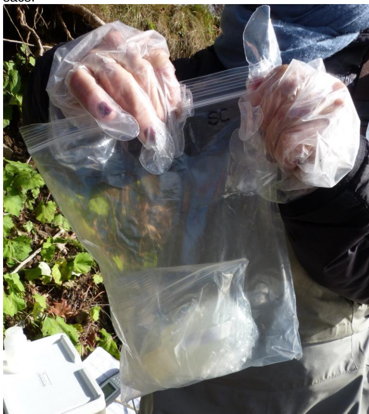
Figure 6. Le préleveur referme rapidement le bouchon de la bouteille de conservation ainsi que les deux sacs.
