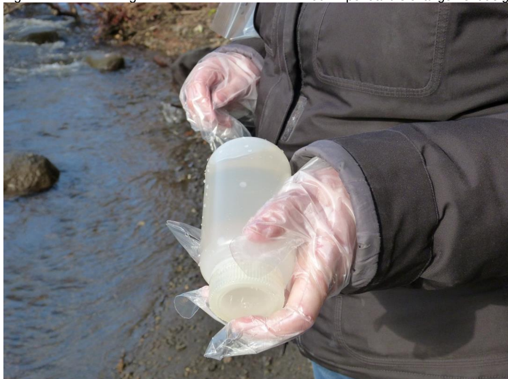
Figure 4. L'assistant agite doucement la bouteille de 250 ml pendant le changement de gants du préleveur.
