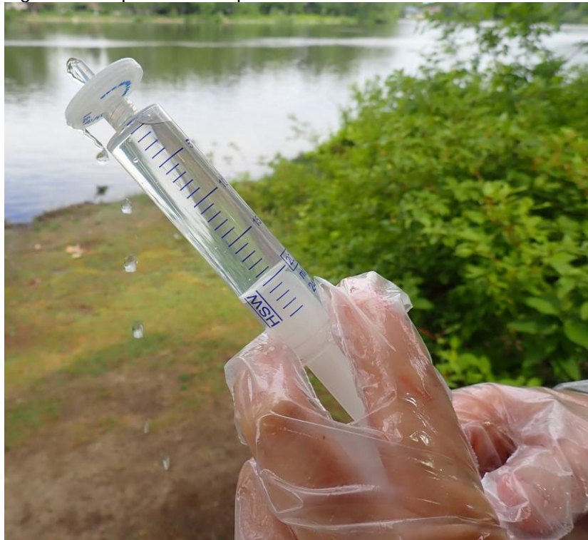
Figure 14. À l'intérieur des sacs, le préleveur filtre 20 ml d'eau de surface dans la bouteille de conservation de 60 ml acidifiée.
