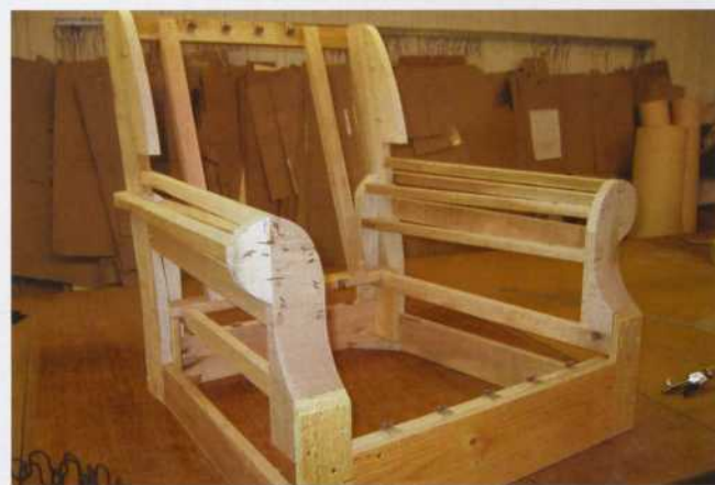
Structure en bois pour un meuble rembourré.
