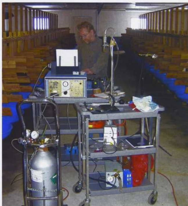
Aperçu du montage servant à réaliser les prélèvements d'air (gaz, micro-organismes) et à mesurer les débits de ventilation (système du gaz traceur SF 6 ).
