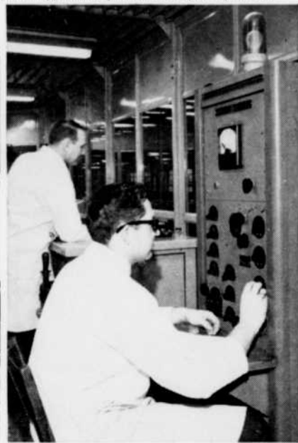
Poste de contrôle du laboratoire; l'on peut apercevoir le pont de Schering, les appareils d'étalonnage et un appareil de prise de vues par impulsion.
