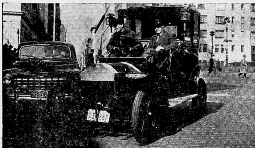
Cette voiture à siège avant découvert et à cabine fermée est une Mercedes Formal de l'année 1905. Ce fut l'une des premières voitures dotées d'un moteur à quatre cylindres. Elle était de "conception audacieuse" à son époque.
