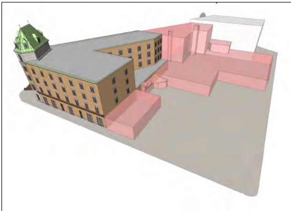
Figure 23. Croquis représentant les bâtiments de la Maison de Lauberivière qui seront conservés et ceux qui seront démolis (Lafond Côté Architectes 2014)
