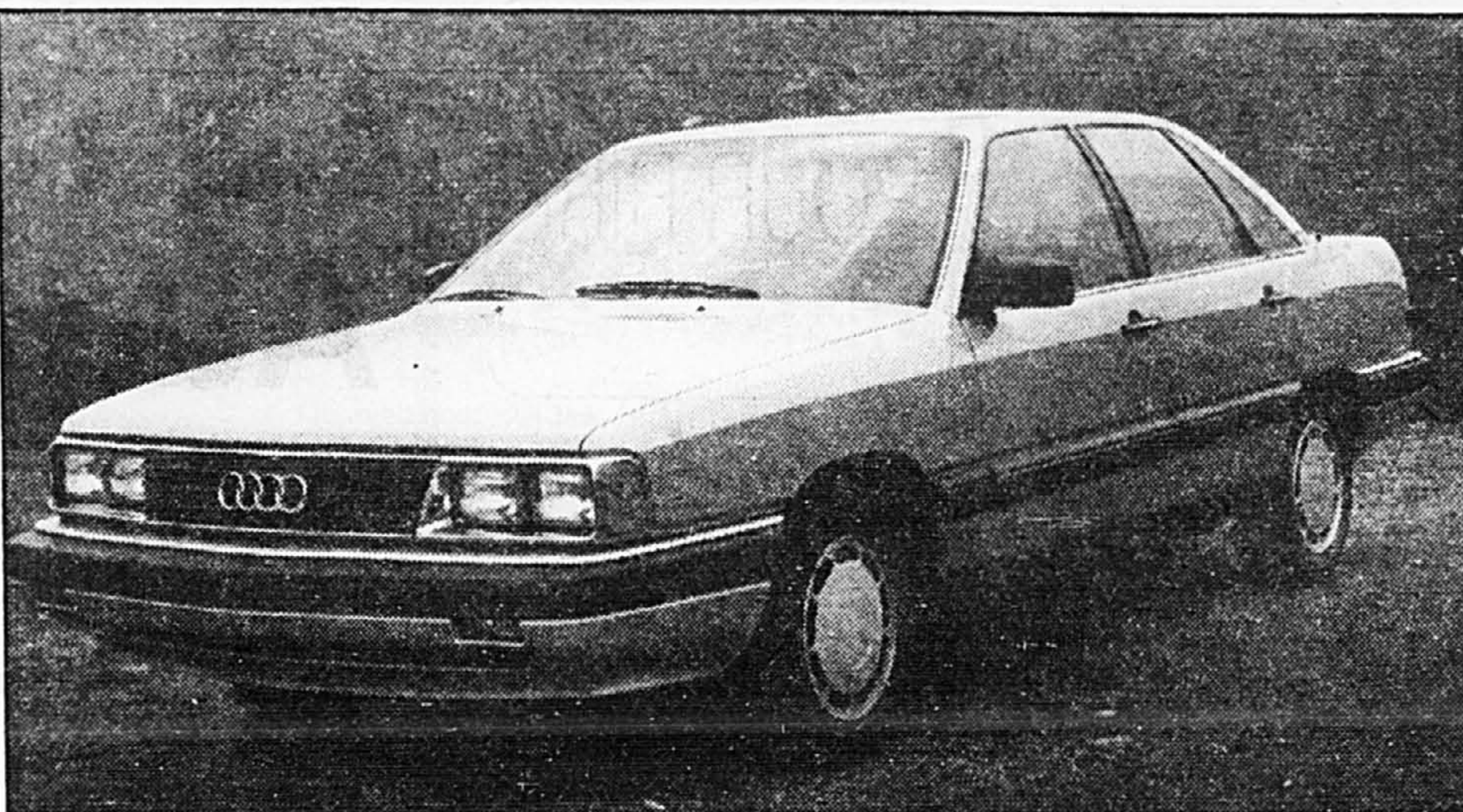
Avec un coefficient de pénétration dans l'air de 0,33, la nouvelle Audi 5000 S 1984 est la voiture de série la plus aérodynamique au monde.
