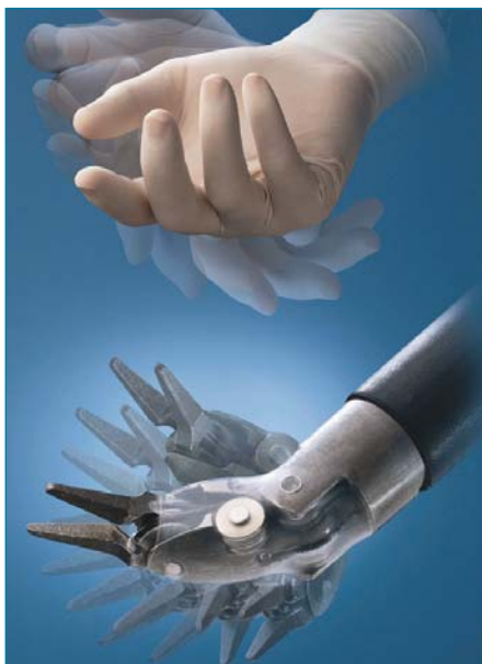
Les bras robotiques du système da Vinci sont uniquement conçus pour imiter les mouvements du poignet humain.
