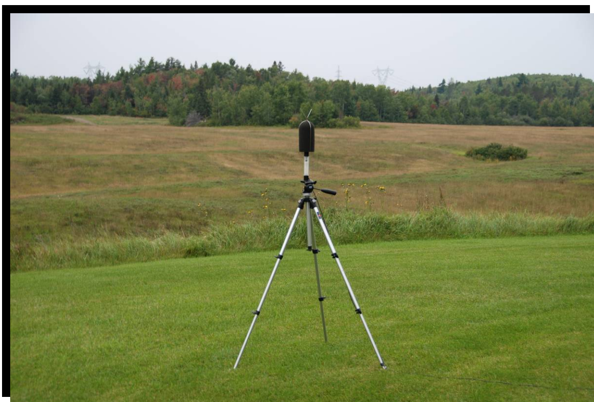
FIGURE 180 Microphone d'un sonomètre installé dans la cour arrière d'une résidence faisant l'objet d'un suivi du climat sonore. Autoroute 70 à Jonquière. (2007.1193)
