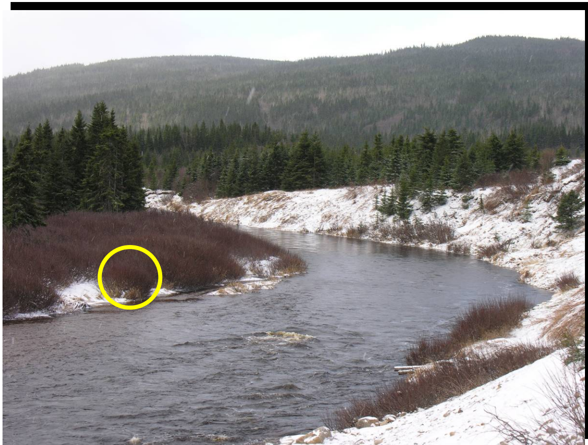
FIGURE 6 Niveau des hautes eaux qui correspond à un débit de récurrence de 2 ans (LNHE). Rivière Cyriac à un débit de 56 \text{ m}^3 par seconde. Route 175 dans la réserve faunique des Laurentides au kilomètre 187,5. (2005.1080)
