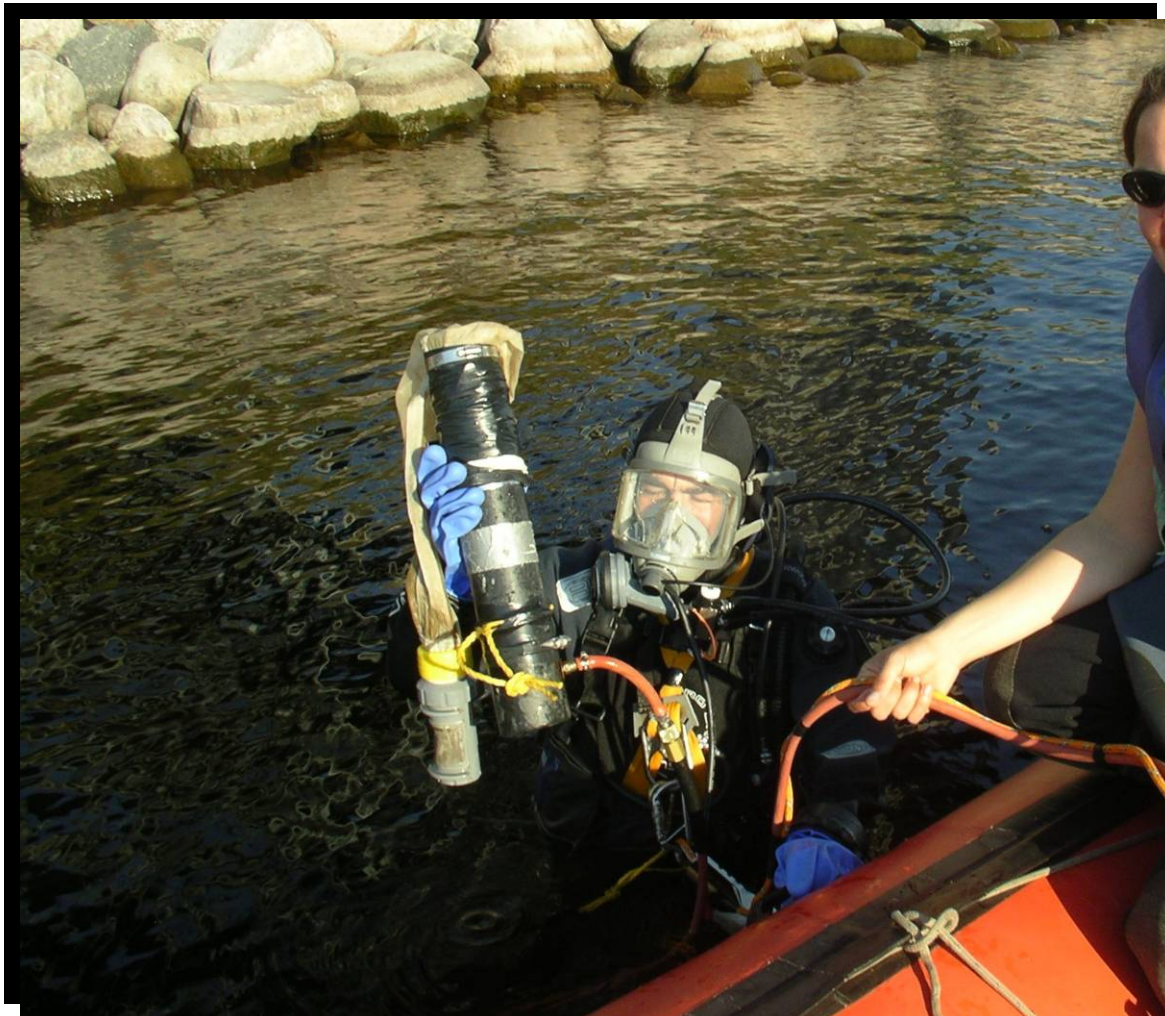
FIGURE 179 Opération d'échantillonnage par plongée afin d'évaluer la production benthique d'une aire d'alimentation aménagée sur le lit de la rivière La Grande Décharge. Suivi d'un programme de compensation de l'habitat du poisson (abri et alimentation) à la suite de la construction d'un pont. Route 169 à Alma. (2004.1154)
