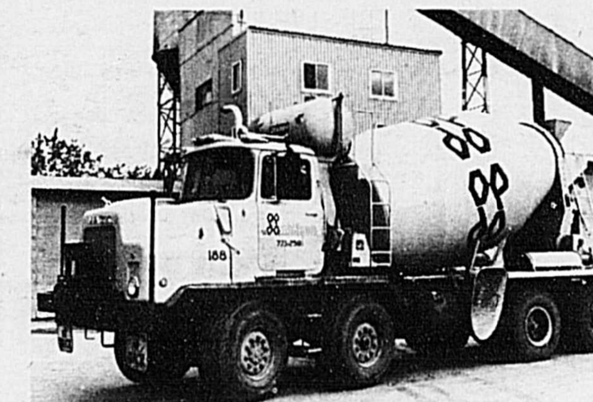
Aujourd'hui: La plus moderne des bétonnières avec son malaxeur en action continue qui donne un béton de 1ère qualité.
