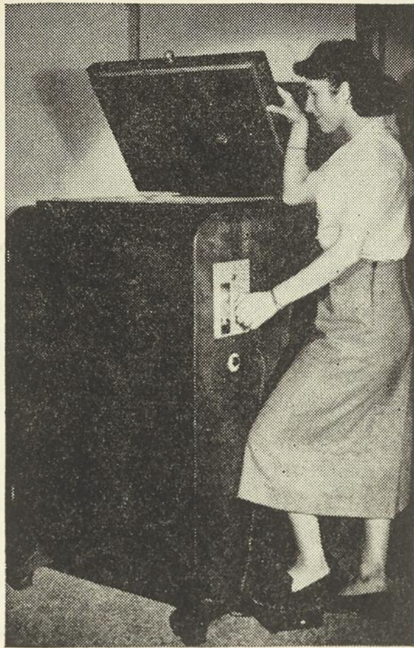
Le « Multiphot » des ateliers S.E.P. loge dans un meuble unique tous les mécanismes nécessaires pour exécuter les opérations de microfilmage (photocopie, tirage, etc.)
