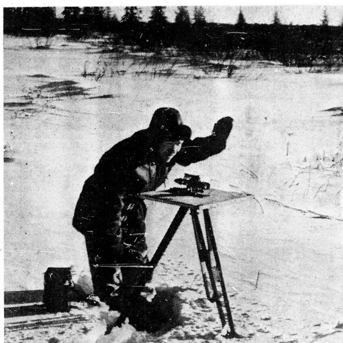
L'INSTALLATION D'UN GEOPHONE — Un technicien installe ici le géophone qui écoutera les réactions souterraines des explosions pour les enregistrer sur le sismographe. Vous remarquerez le câble noir: déjà ce câble était de teinte orange mais il apportait trop d'attrait pour les petits animaux qui le rongeaient et on dut en changer la couleur.
