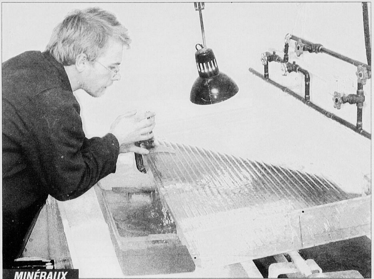
Robert Gagnon, géologue, vérifie minutieusement les pré-concentrés de minéraux lourds sur la table à secousses.
