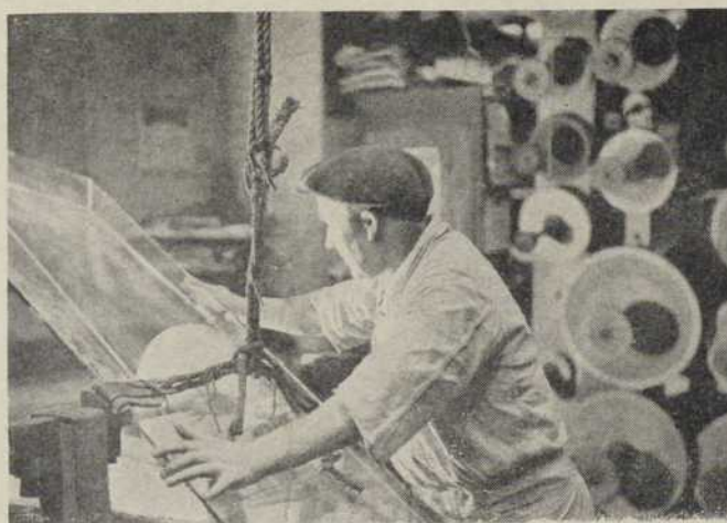
3—Le diamètre des meules varie de 12" à 36" et leur épaisseur de 3/4" à 1". Si la glace travaillée est petite, elle peut être tenue dans les mains, mais, si elle est grande, elle est suspendue et contre-équilibrée afin que le tailleur en brillant soit sûr d'une touche délicate quel que soit le poids de la glace.
