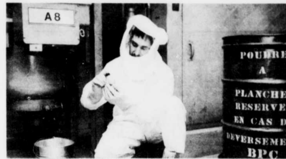
Les employés appelés à effectuer des échantillonnages sur des appareils contaminés aux BPC doivent revêtir un équipement les empêchant d'être en contact direct avec ces produits.
