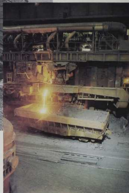
Coulée de scorie de titane dans un wagon à l'usine de QIT de Sorel.
